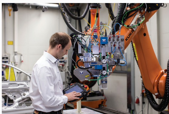
Novi postopek daljinskega laserskega varjenja je računalniško nadzorovan.
