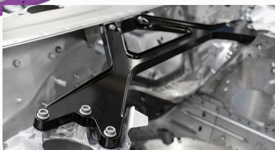
↑ Iz magnezija je izdelana prečna ojačitev motornega prostora, zagotavlja pa prihranke pri masi in večjo trdnost.
